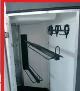
Sattelkammer mit ausziehbaren Sattelhaltern für Westensättel
