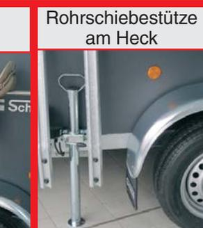
Rohrschiebestütze am Heck
